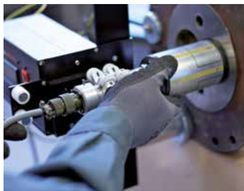
Mesure directement sur la ligne d'extrusion. Plage de mesure des capteurs: 47 à 133 mm de diamètre.
