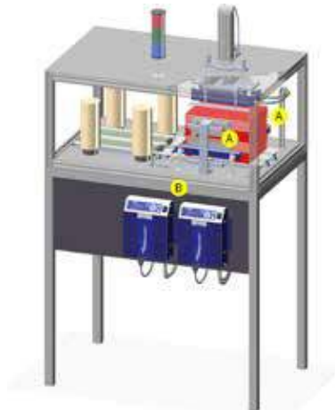
A Barre de charge B Alimentation haute tension
