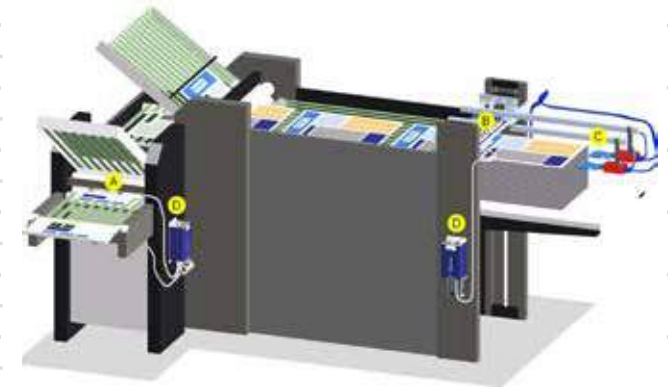
A Barres antistatiques B Barre antistatique C Bec plat D Alimentation
