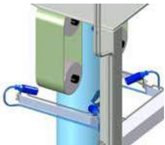
A Barres antistatiques B Becs à air ionisé C Alimentation
